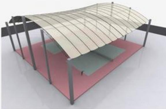
**Paragola** dapat diaplikasikan pada bangunan seperti carport dan void. Sangat hemat listrik karena dilengkapi baterai cadangan dan pengoperasian secara otomatis dengan bantuan control panel dan remote control hingga radius 200 meter.
